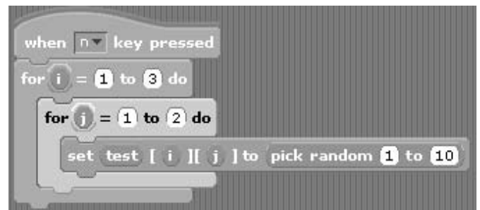
Bilder 9 und 10: Nachbildung einer Zählschleife.
